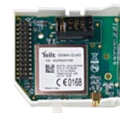
GSM-350 Transmetteur GSM/GPRS Antenne intégrée Transmission Digitale et IP vers télésurveilleur Transmission SMS et Vocal vers utilisateur Connexion à l'application smartphone
